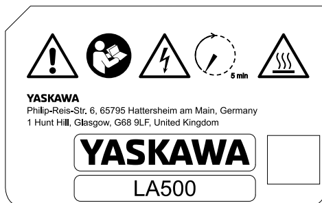
Figura 5.3 Rótulo de advertencia "Riesgo de descarga eléctrica"
