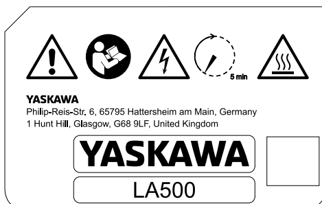
Obrázek 6.3 Výstražný štítek “Nebezpečí úrazu elektrickým proudem”
