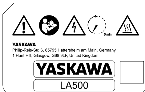
Figure 3.3 Étiquette d'avertissement « Risque de choc électrique et d'électrocution »
